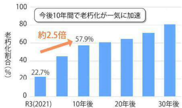
図2 管路の老朽化予測
