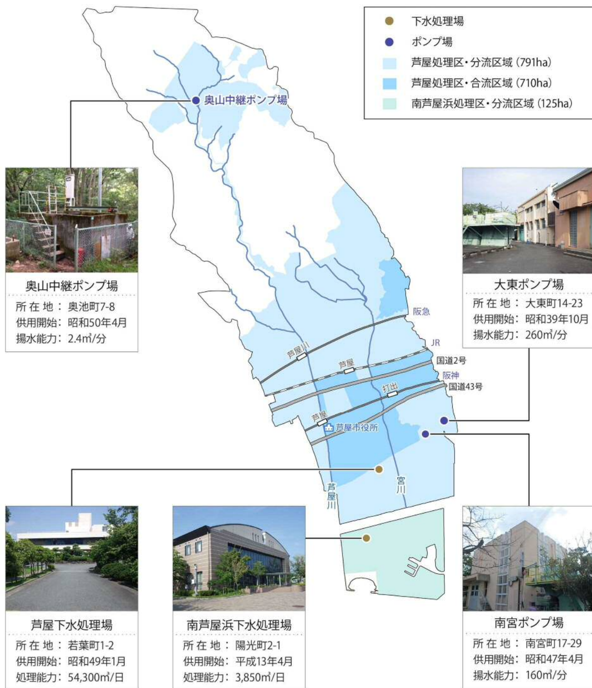
図 1 芦屋市の下水道施設
