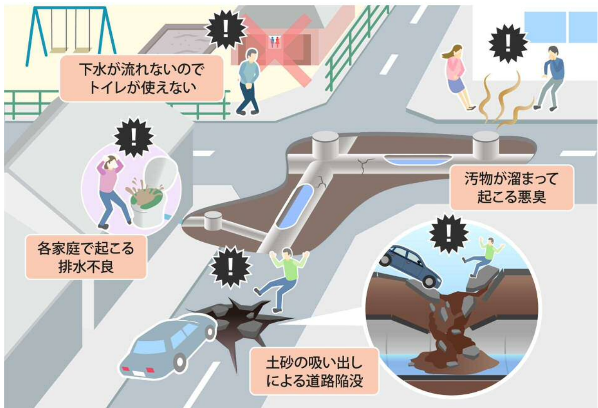
【老朽化した管路による様々な被害】
