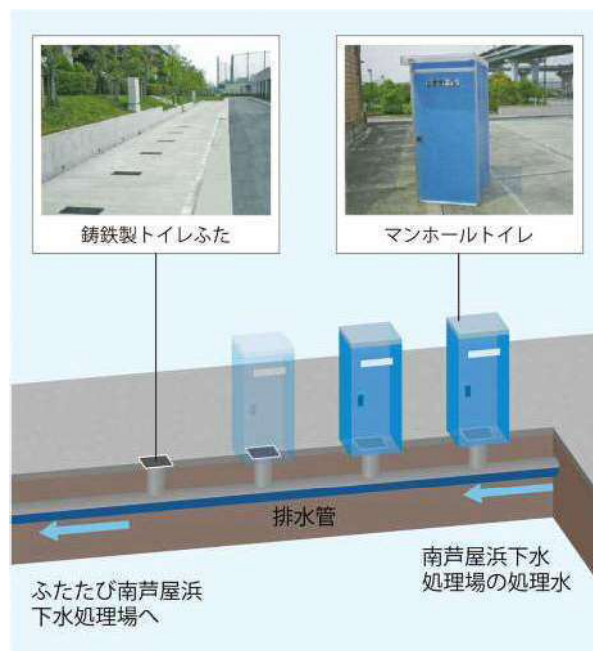
図6 マンホールトイレ（南芦屋浜下水処理場）
