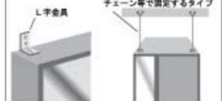
■重ね留め用金具 重ねた上下の家具を固定し、上の家具の落下・転倒を防ぐ。
