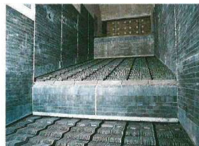
火格子 焼却装置も高クロム耐熱耐摩耗鋼製の往復動階段火格子(3段)で構成され、攪拌性を高める反転グレートブロック装置も配しています。
