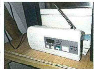
緊急地震速報連動ラジオ (本施設実例)
