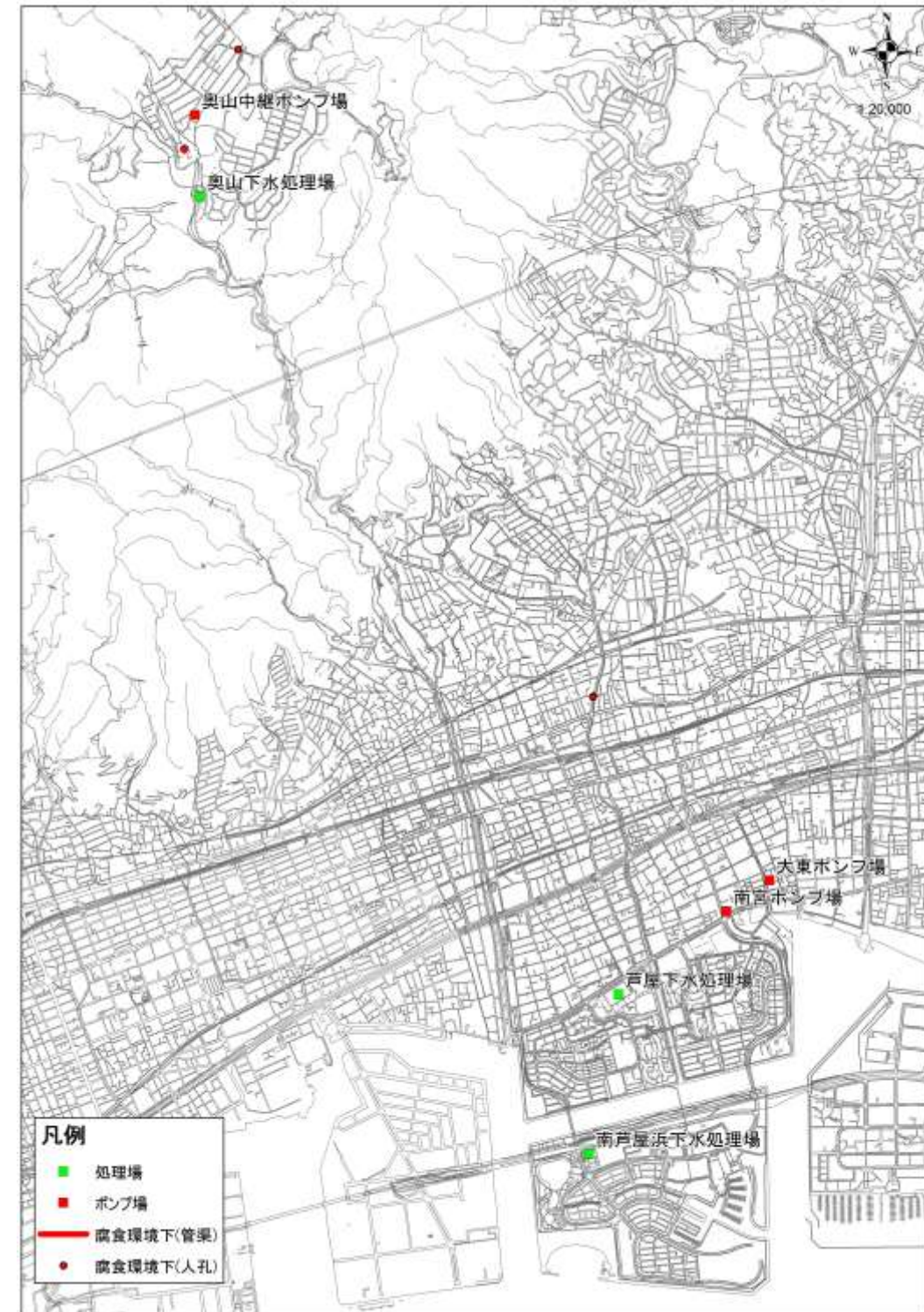
図 8-3 腐食環境下の管渠(圧送管下流、伏越管上下流)
