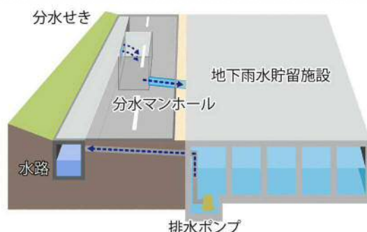
図 18 地下雨水貯留施設
