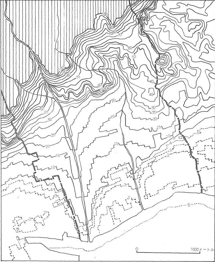
図26 芦屋平野地盤高図（国土地理院2万5千分1土地条件図等による）
