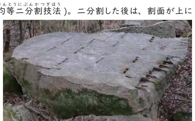
写真20：並行分割技法を用いた割石
