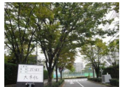
建築限界の侵害（車道側）
